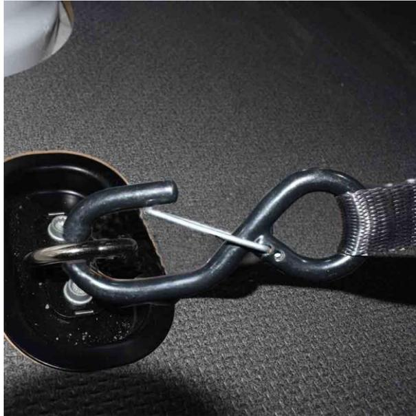
4. Spanngurt straff ziehen und mit der Ratsche den Spanngurt spannen.
