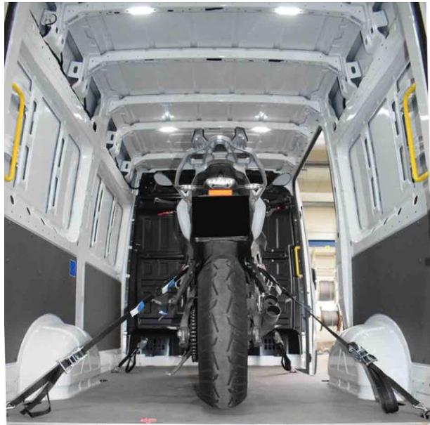
5. Gurte abwechselnd so spannen das das Vorderrad bzw. Hinterrad etwas einfedert.
